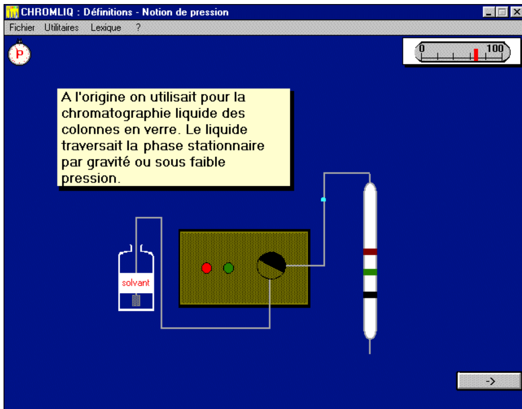
Fig. 4.2 Image de l'animation de la chromatographie sous faible pression.
